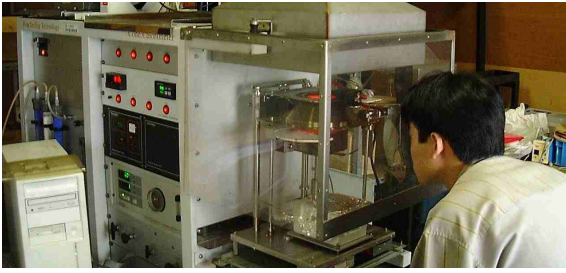
Fig. 2-8 Prueba de fuego en Japón, ISO 5660-1
